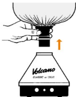
9. Vyměte z přístroje balon i s komorou
