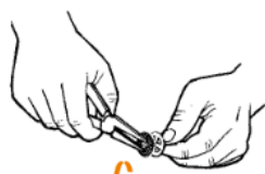
6. Odšroubujte matici z vrchního krytu plnicí komory
