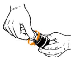
9. Odšroubujte válec plnicí komory
