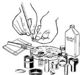
11. Ruční čištění alkoholem (min. 90%), je možné vložit i do myčky
