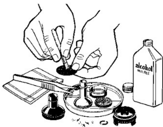
Ruční čištění izopropylalkoholem (min. 90%)
